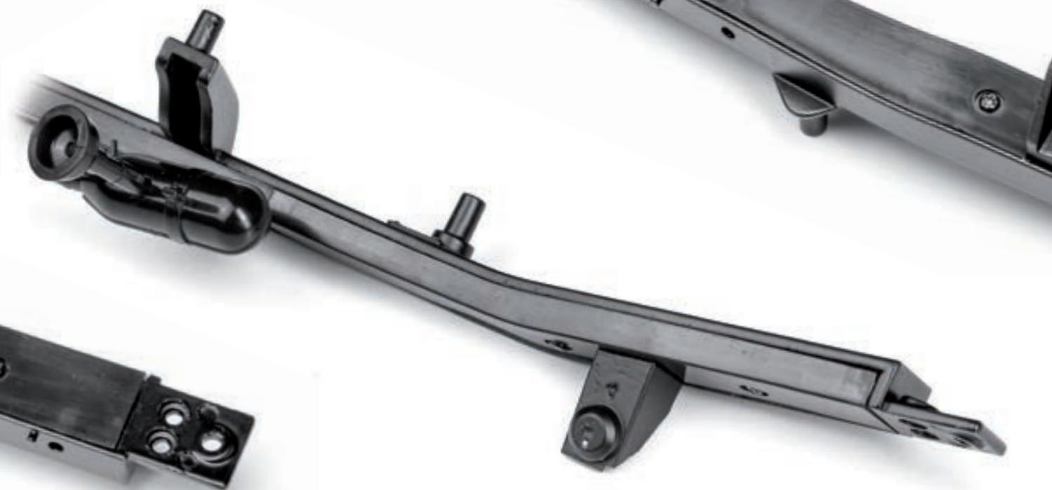
**Шаг 7.** Установите передний правый кронштейн крепления кузова в среднюю часть правого лонжерона рамы (внешняя часть). Кронштейн имеет маркировку «Б». Совместите крепежные и центровочные отверстия деталей и закрепите кронштейн винтом 2,3×6 (JM).
