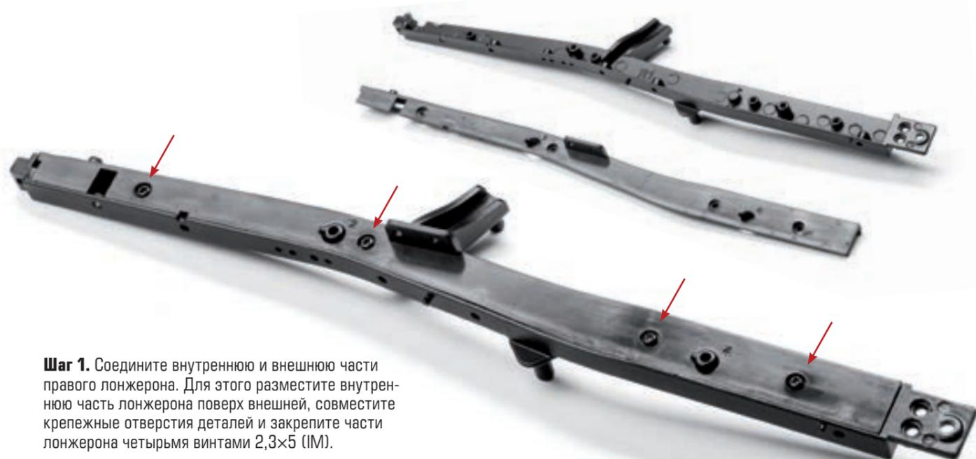
**Шаг 1.** Соедините внутреннюю и внешнюю части правого лонжерона. Для этого разместите внутреннюю часть лонжерона поверх внешней, совместите крепежные отверстия деталей и закрепите части лонжерона четырьмя винтами 2,3×5 (IM).
