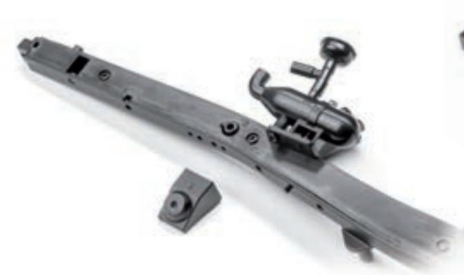
**Шаг 6.** В средней части правого лонжерона, перед котлом подогревателя, установите правый передний кронштейн крепления двигателя (деталь имеет маркировку «2»). Для фиксации детали используйте винт 2,3×6 (JM).
