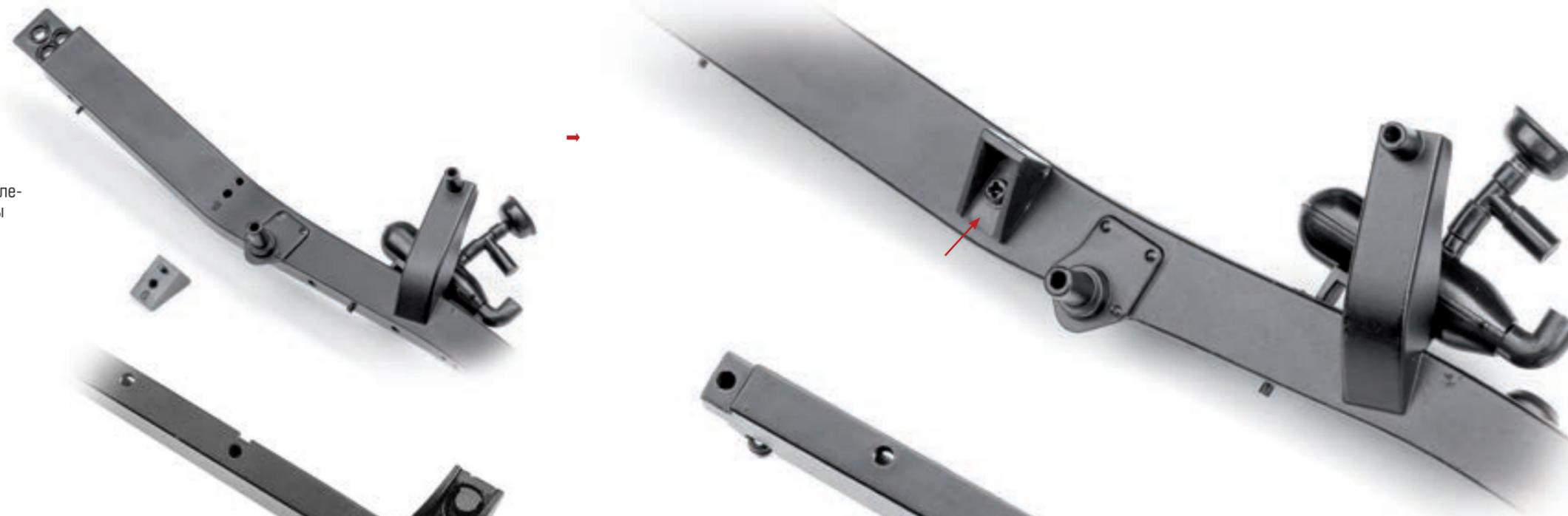
**Шаг 8.** На нижней плоскости передней половины правого лонжерона установите и закрепите двумя винтами 1,7×5 (DM) буфер рессоры.
