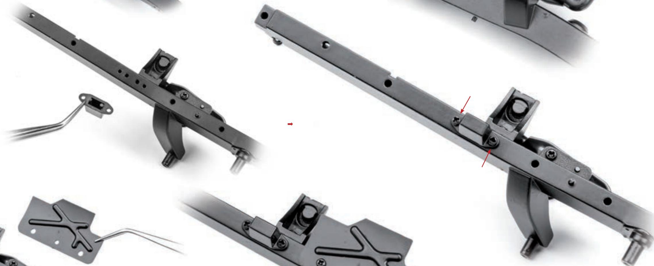
**Шаг 9.** Рядом с буфером на нижней плоскости лонжерона установите правый брызговик двигателя. Зафиксируйте деталь двумя винтами 2,3×5 (IM).
